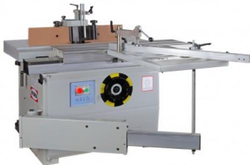
Станок предназначен для плоскостной, профильной и фасонной обработки резанием заготовок из дерева.
