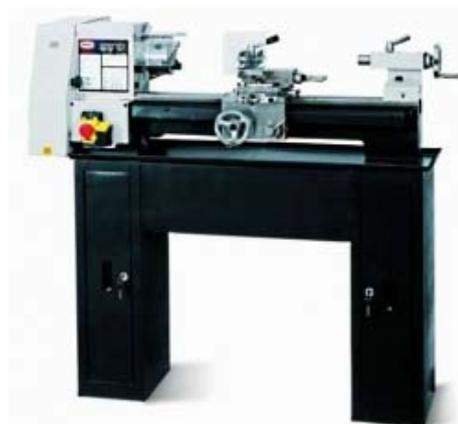
Универсальный токарный станок Prota SPA-500 предназначен для обработки тел вращения путём снятия с них стружки при обточке. На станке можно выполнять различные виды токарной обработки: обтачивание цилиндрических, конических, фасонных поверхностей, подрезку торцов, отрезку, растачивание, а также сверление и развёртывание отверстий, нарезание резьбы и накатку рифлений, притирку и т.п.
