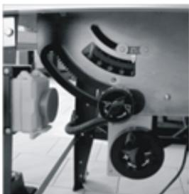
Диск пилы можно установить с помощью управляющего колеса на резание под углом 0-45. С помощью колеса можно изменять прорез диска пилы.
