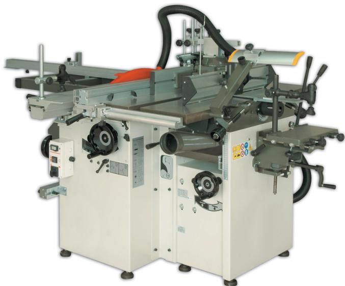
Комбинированный станок ML353G предназначен для работы на деревообрабатывающем производстве и в любой столярной мастерской.
