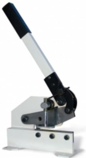
Рычажные ножницы для разрезания металла hs-6, производства фирмы Prota широко используются для резки металлических листов, кругляка, уголков и прочего. Можно также применять их для перерезания металлических труб с небольшим диаметром. Ножницы легко справятся с листовой сталью средней твердости, а также с мягкими металлами.
