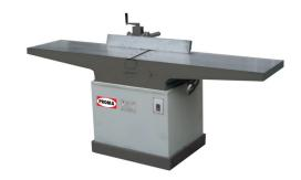
Фуговальный станок hp 400 помогает придать обрабатываемым заготовкам завершенный вид, правильную форму и создать гладенькую поверхность. Также с помощью это устройства можно придать детали точные размеры. На этом станке обрабатываются плоские детали с одной стороны. Основным рабочим инструментом станка являются тонкие ножи из высококачественной стали, закрепленные на рабочем валу.
