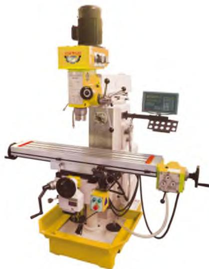
Вертикально-фрезерный станок FHX-50PD используется в ремонтных мастерских и цехах, на мелком и крупном серийном производстве для обработки корпусов и деталей, выполненных из черных и цветных металлов.
