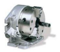
Делительная головка DH-2 используется при разметке, сверлении, фрезеровании и шлифовании. Предназначена для деления заготовки на равные или неравные части. Возможно горизонтальное и вертикальное использование. Позволяет производить деление на 2, 3, 4, 5, 6, 8, 12 и 24 частей.
